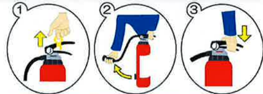
安全栓を引き抜く ノズルを火元にむける レバーを強く握る
